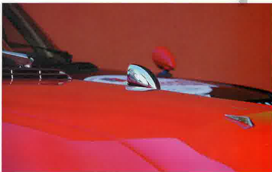
Lo specchietto retrovisore della Rallye 1600 nei modelli sia da gara che di serie, era il Vitaloni Sebring "versione piccola", in plastica cromata. I collezionisti di oggi usano anche lo specchio cromato rotondo.
